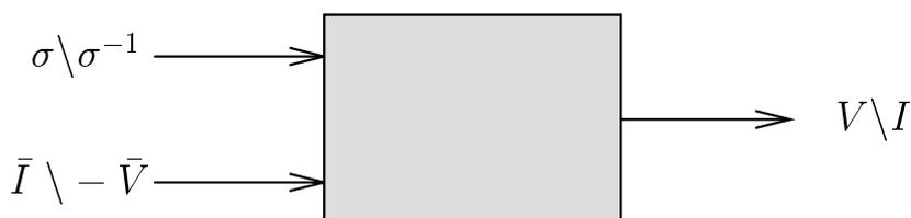
FIG. II.2 - Symétrie de la résolution du problème direct avec la formulation intégrale. La résolution du problème  $V, \sigma \rightarrow I$  s'effectue avec le même opérateur que le problème  $I, \sigma \rightarrow V$ , en permutant les entrées à un signe près et en inversant la conductivité.
